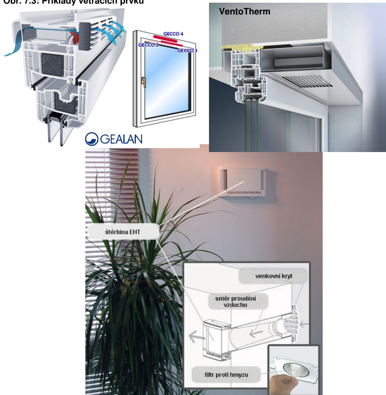
Obr. 7.3: Příklady větracích prvků
