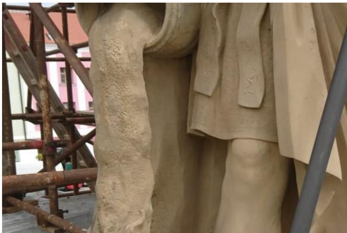
Degradace materiálu doplňků i originálního kamene
